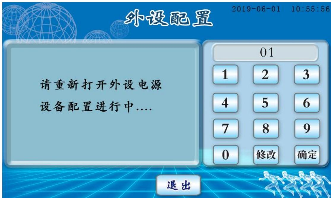
**注意:** 一台设备多台外设使用时, 配置时候一定注意外设配置的顺序, 如连续配置一直点“**确定**”即可, 若单独配置某一个外设, 点击“**修改**”输入需要配置的外设号(必须是两位, 如第二个外设, 应输入**02**然后点“**确定**”进行配置, 参考**3.5.1.2**)。
