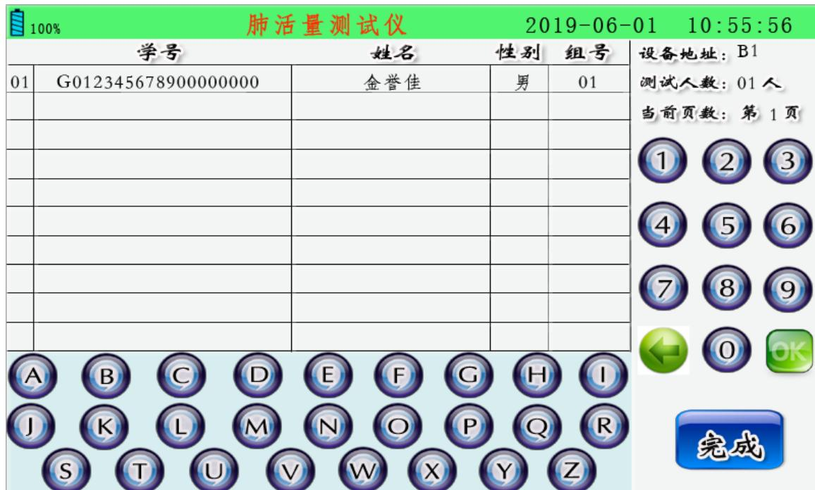
3. **OK 键:**输入完成一条信息后,点“”,进入下一条信息输入,学号自动累加;
