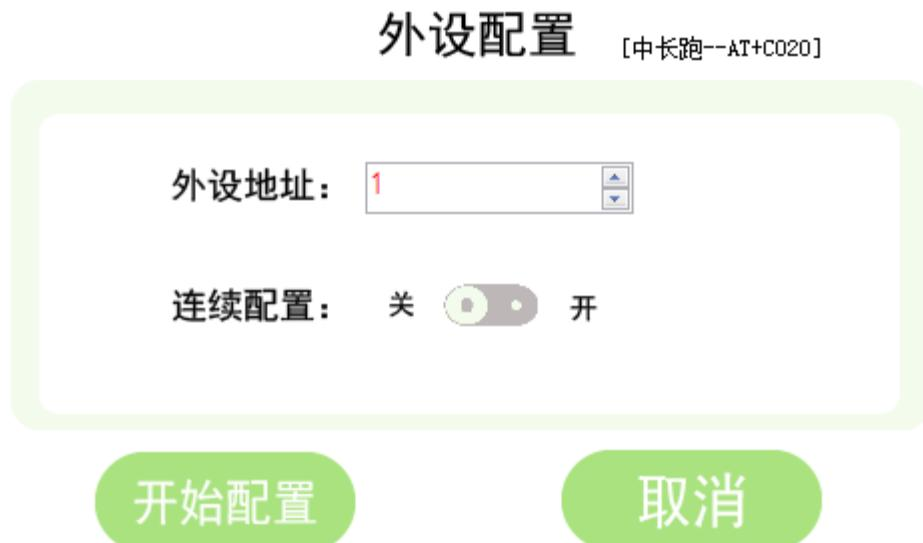
左上角显示的是设备类型和信道地址；外设地址是要配置的设备地址，默认是从 1 开始，如果有多套设备，则外设地址依次需要递增配置；在多套设备都需要配置的情况下，可以将连续配置开关打开，这样在配置完一套设备后，外设地址自动累加，就不用每次都点击增加了，特别适用于跳绳等多个设备的情况下。设置好外设地址后，点击开始配置按钮，则在界面中间出现提示信息，如下所示：
