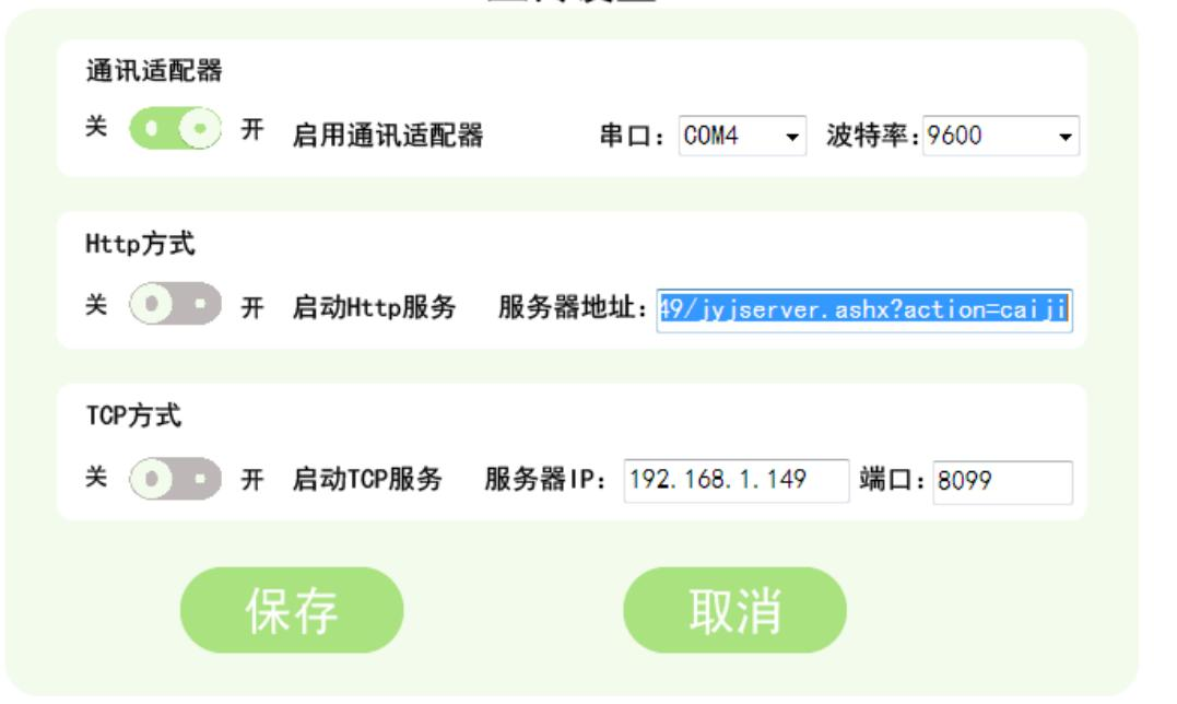
**通讯适配器:** 是配置通讯适配器串口和波特率等参数，如果用通讯适配器必须将开关打开。
